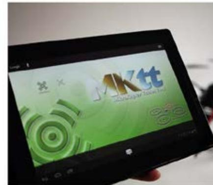
Das MK "Koptertool" Software Paket (für Windows Systeme) und das „MikroKopter Tablet Tool“ für Android Endgeräte. Zur wegpunktebasierten Flugplanung und Konfiguration der Drohne.
