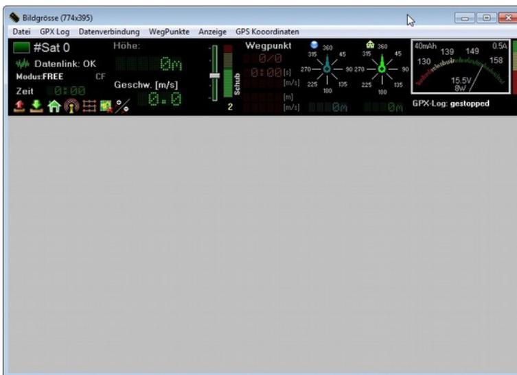
Ist der ARF-MikroKopter eingeschaltet, werden über das Bluetooth-Set sämtliche Telemetriedaten im oberen Feld des „OSD“ angezeigt. Diese sind z.B. Akkuspannung, Anzahl der empfangenen Satelliten, eingestellte Funktion, Höhe, etc.
