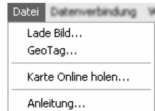
Die so gespeicherten Kartenausschnitte können dann über *Lade Bild...* in das Wegpunkteprogramm geladen werden. In diese Karte können nun mit je einem „Rechtsklick“ der Maus beliebige Wegpunkte abgelegt werden.
